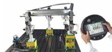
Aktueller Versuchsaufbau mit kabellosem mobilen Panel
