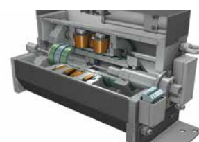
Linearmotor mit integriertem Kraftübersetzer der Firma Ortlinghaus
