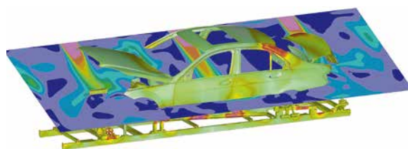
Bild 4: Innovative Anströmdüsenkonzepte ermöglichen eine gleichmäßigere Karosserieerwärmung bei gleichzeitig kürzeren Trocknungszeiten. Quelle: Daimler AG
