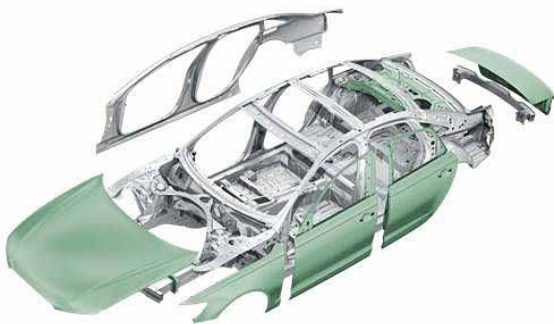
Zerlegung der Karosserie in Module Quelle: Audi AG
